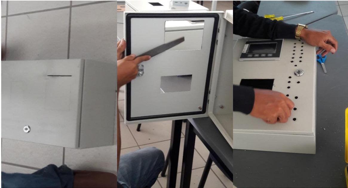
**Figura 16.** Señalizaciones, cortes y perforaciones del primer gabinete construido.
