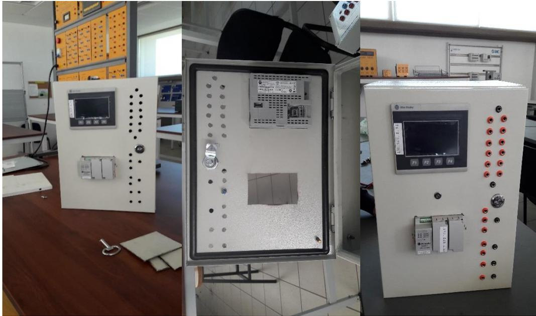
**Figura 17.** Colocación de la Panel View, del PLC y de los conectores banana hembra (jacks banana hembra), en el primer gabinete construido.
