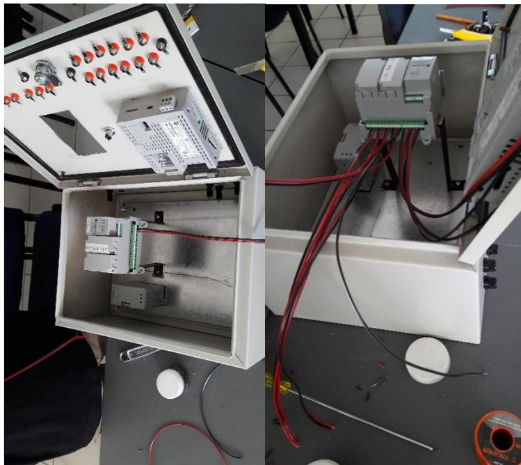
**Figura 22.** Colocación de los cables correspondientes en el PLC del gabinete.
