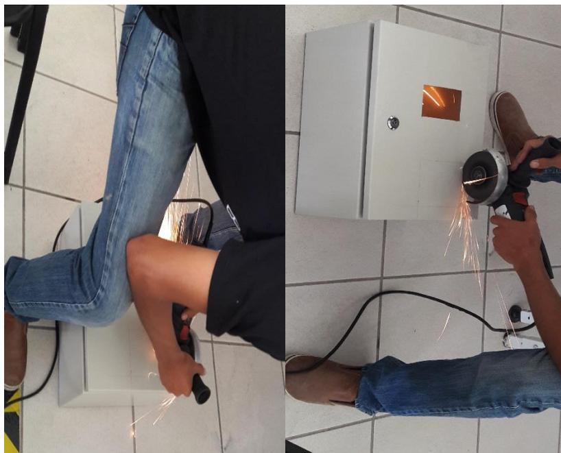
**Figura 32.** Proceso de corte de las ranuras para la Panel View y el PLC, en los gabinetes.
