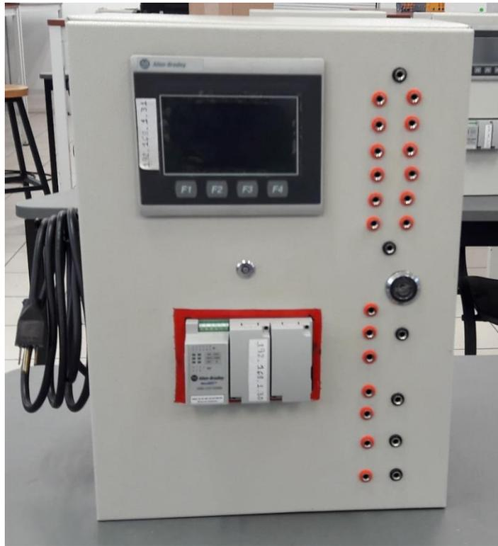
**Figura 40.** Muestra de uno de los gabinetes, totalmente construido y funcional.
