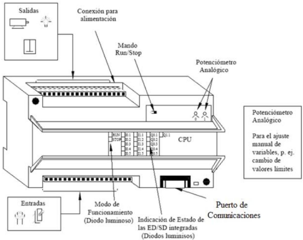
**Figura 5.** Estructura externa de un PLC.
