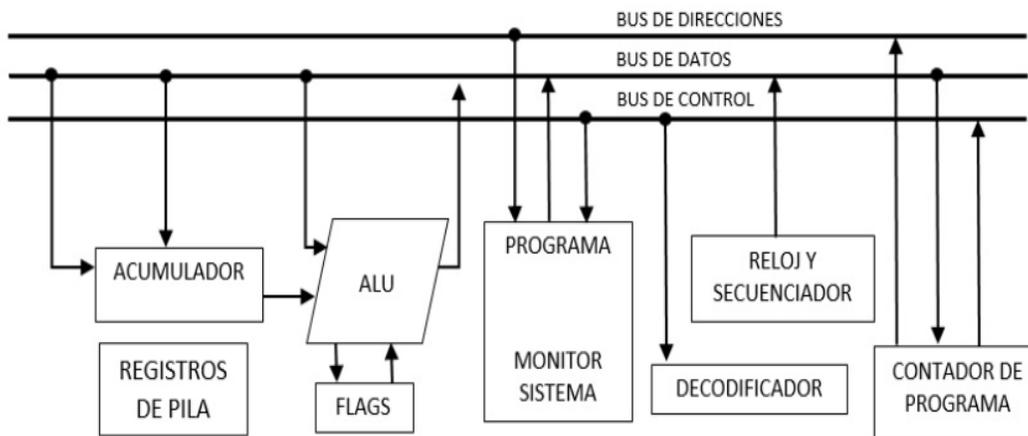
**Figura 4.** Diagrama interno de la CPU de un PLC.
