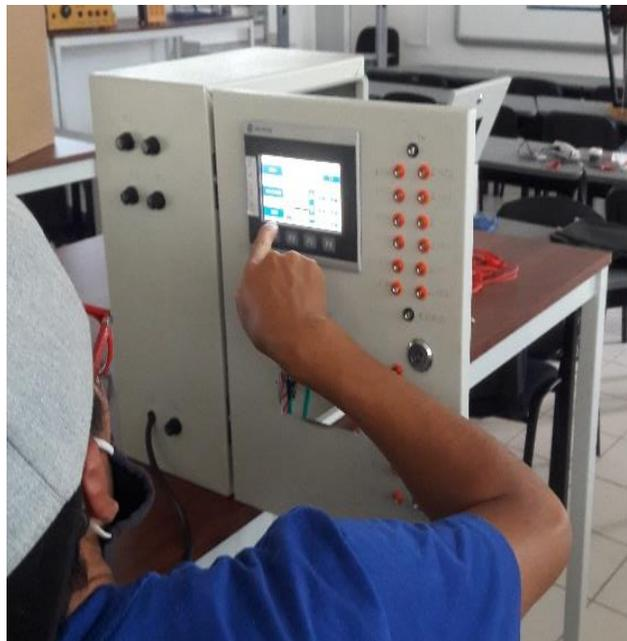
**Figura 28.** Configuración de la Panel View y el PLC, dentro del gabinete.
