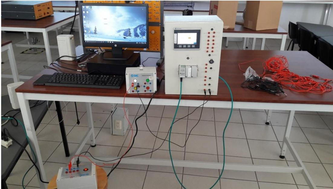
**Figura 29.** Ejecución de un programa con su respectivo circuito eléctrico, como parte de una prueba del funcionamiento del gabinete.
